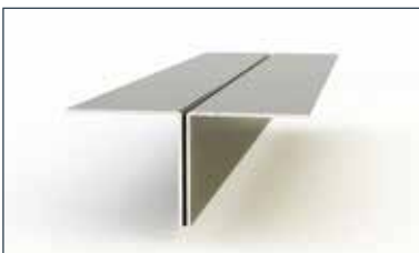
10. Cembit Plank T-samleprofil 25 x 30 x 30 mm lakkert aluminiumsprofil til vertikal sammenføring av planker
